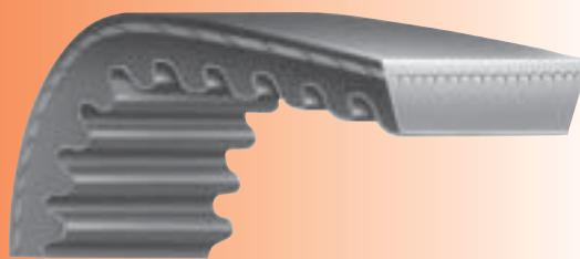
Correa síncrona con un diente a perfil curvado, diseñado para transmitir el par y alta potencia. El perfil optimizado proporciona gran resistencia, una distribución uniforme de las fuerzas aplicadas y un ruido de funcionamiento reducido. Buena resistencia a los aceites que se utilizan normalmente y a temperaturas entre -25 °C y + 100 °C.
