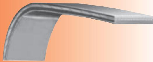
Correas llanas sin fin, con cables en poliéster, revestimiento de goma, espesor de 1,2 mm, utilizadas en aplicaciones de alta velocidad de máquinas textiles, maquinas de carpintería y para cualquier aplicación que necesite correas llanas.
